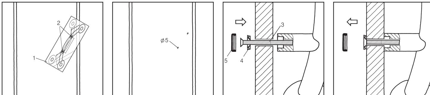
**D** Anreißschablone (1) an Tür ausrichten und Bohrpunkte (2) markieren.
