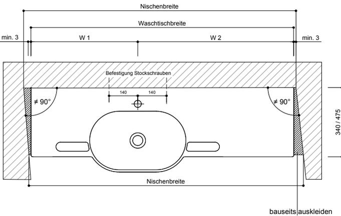
1. Exaktes Aufmaß der Wand nach Fertigstellung der Wandoberfläche in Einbauhöhe des Waschtisches nehmen.
