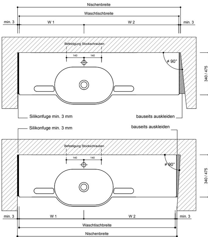
1. Exaktes Aufmaß der Wand nach Fertigstellung der Wandoberfläche in Einbauhöhe des Waschtisches nehmen.
