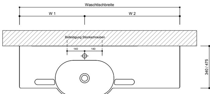
1. Exaktes Aufmaß der Wand nach Fertigstellung der Wandoberfläche in Einbauhöhe des Waschtisches nehmen.
