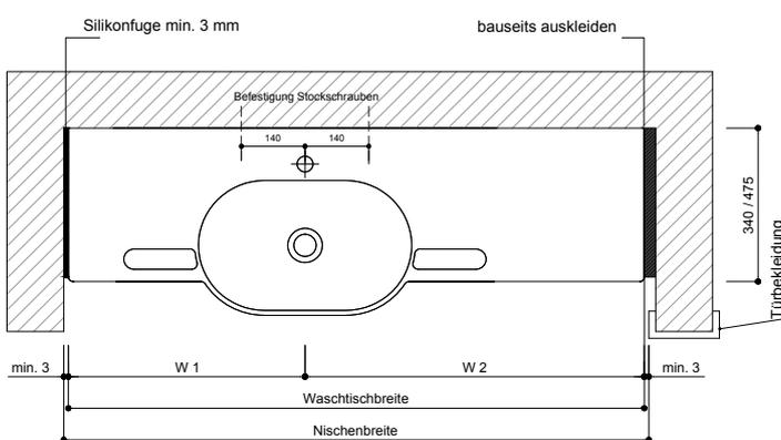
1. Exaktes Aufmaß der Wand nach Fertigstellung der Wandoberfläche in Einbauhöhe des Waschtisches nehmen.
