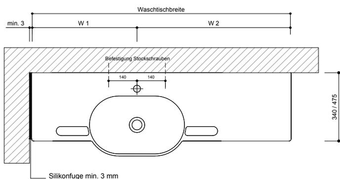
1. Exaktes Aufmaß der Wand nach Fertigstellung der Wandoberfläche in Einbauhöhe des Waschtisches nehmen.
