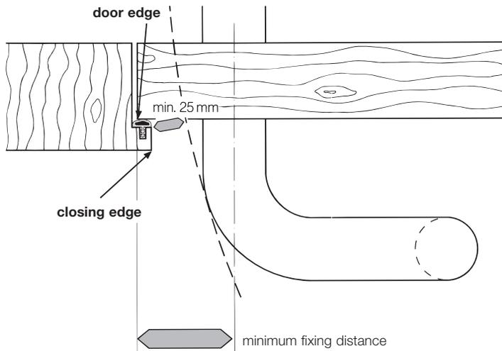
**Safety margin between door handle and closing edge according to DGUV (Deutsche Gesetzliche Unfallversicherung)**
