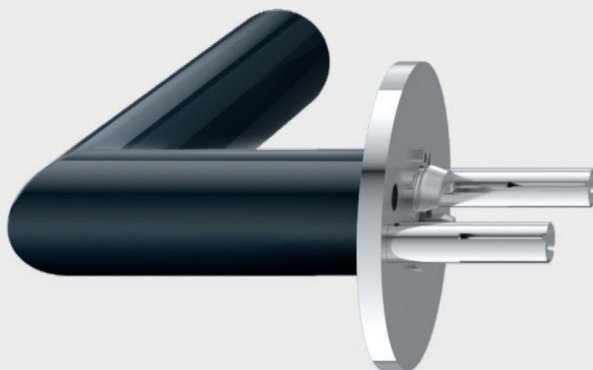
La technologie de montage innovatrice des rosaces plates permet une fixation extrêmement rapide et durable sans vis. Pour la fixation, les douilles de verrouillage et boulons filetés sont emboîtés les uns dans les autres de façon à réaliser une fixation résistante à la traction. La connexion rapide permet un montage et un démontage simples. Les garnitures coupe-feu selon DIN 18273 complètent la gamme.
