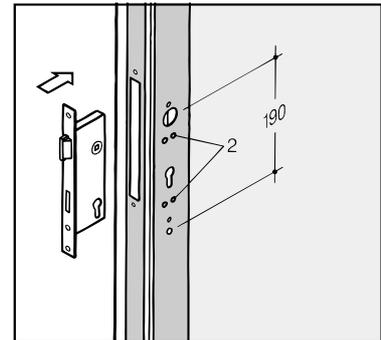
**2.** Bei Montage mit Einnietmuttern M5 (2) 4 Einnietmuttern je Seite setzen. Bohrloch 8mm  $\varnothing$  für Kabel anzeichnen und bohren.
