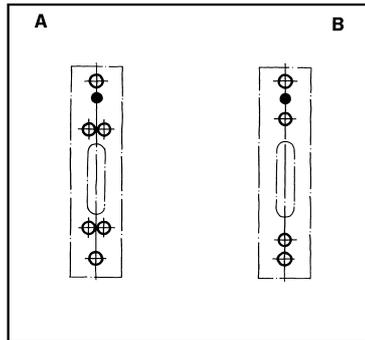
**1a.** Bohrbild (A) für Montage mit Einnietmuttern M5 verwenden. Bohrbild (B) für Montage mit durchgehender Verschraubung (ausgenommen Feuerschutztüren) verwenden.
