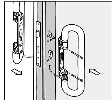
**5.** Kabel einschieben, Unterteile an Profilkante ausrichten und mit durchgehenden Schrauben befestigen. Bei Montage mit Einnietmuttern Unterteile mit M5 Schrauben befestigen.
