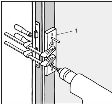
**1.** HEWI Bohrlehre BL550.08 (1) an Profilkante ausrichten und mit Schraubzwingen befestigen. Bohrlöcher 7mm  $\varnothing$  nach Bild **1a** auf beiden Seiten der Tür bohren. Schloß demontieren.
