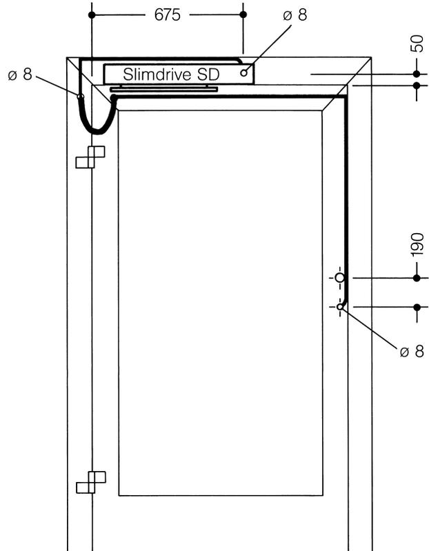
Kabel (LiYY 4 x 0,25 mm<sup>2</sup>; Ø 4,1 mm) beiliegend, Länge 3,5 m
