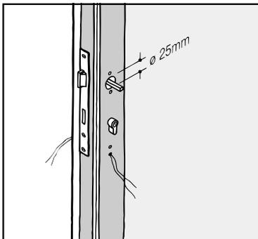
**3.** Kabel abisolieren und durch Bohrung stecken. Schloß montieren. Profilzylinder einsetzen und Vierkantstift (3) einstecken.
