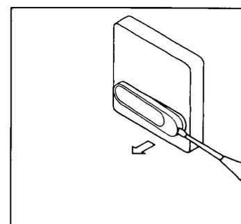
**D** Befestigungspunkte durch Unterteil anzeichnen. Schraub- oder Dübellöcher für 4 mm Schrauben bohren.
