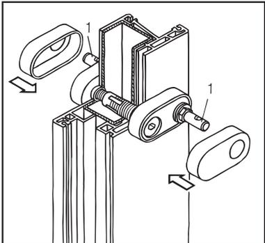
4. Spezialschrauben (1) ausrichten. Entsprechende Kappen für Griff 30 mm  $\varnothing$ , 33 mm  $\varnothing$  oder 40 mm  $\varnothing$  aufstecken.
