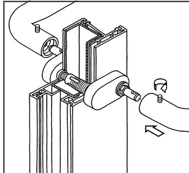
5. Griff von beiden Seiten aufstecken. Gewindestift mit Sechskantschlüssel SW 3 festschrauben.
