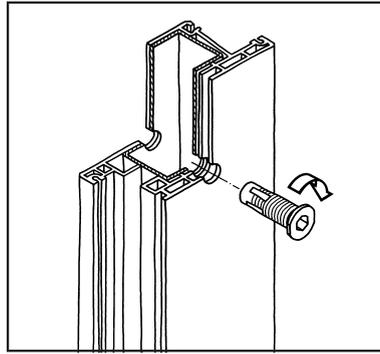
2. Montagehülse bündig mit langem Sechskantschlüssel (SW 10) eindrehen.
