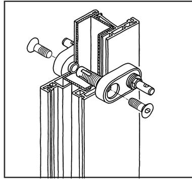
3. Senkschrauben eindrehen, mit Sechskantschlüssel (SW 6) festziehen.
