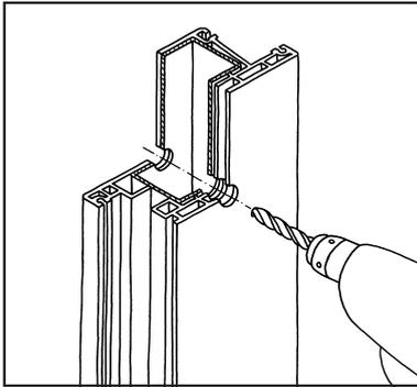
1. Bohrung für Montagehülse 14 mm  $\varnothing$  bohren.
