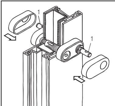
4. Spezialschrauben (1) ausrichten. Entsprechende Kappe für Griff 30 mm  $\varnothing$ , 33 mm  $\varnothing$  oder 40 mm  $\varnothing$  aufstecken.
