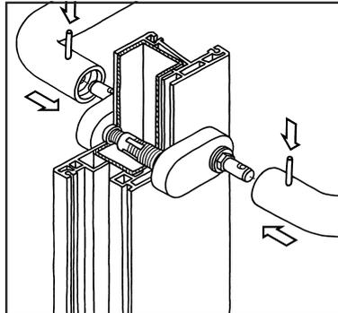
5. Griffe von beiden Seiten aufstecken. Stifte mit leichtem Hammerschlag einsetzen.
