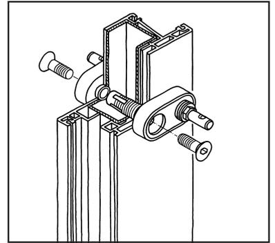
3. Senkschrauben eindrehen, mit Sechskantschlüssel (SW 6) festziehen.
